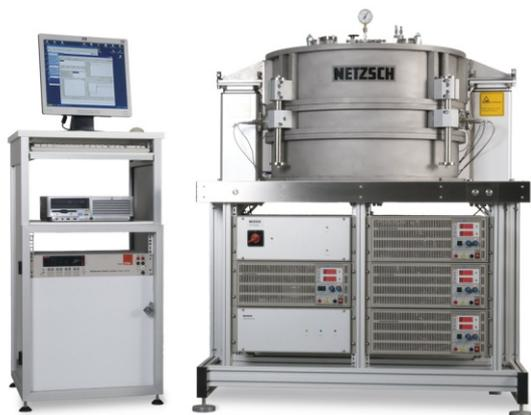
图1 德国耐驰公司GHP 456导热测试设备
