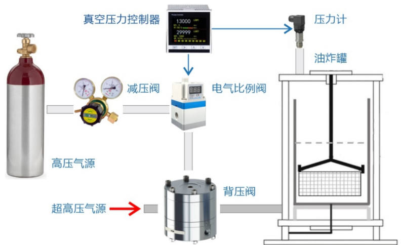
图5 油炸装置超高压控制系统结构示意图
